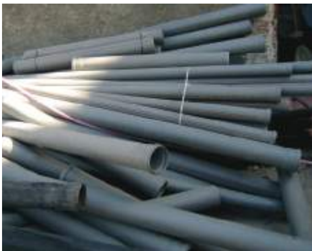
نحوه انبارش نادرست
