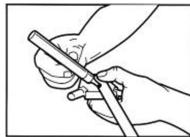
روش علامت زدن بر روی لوله به وسیله کالیبراتور سه طرفه
